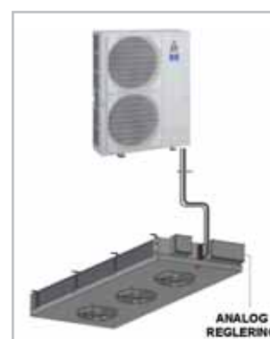
Ohjaus analogisella signaalilla 0-10V/4-20 mA yhdelle tai useammalle laitteistolle.
